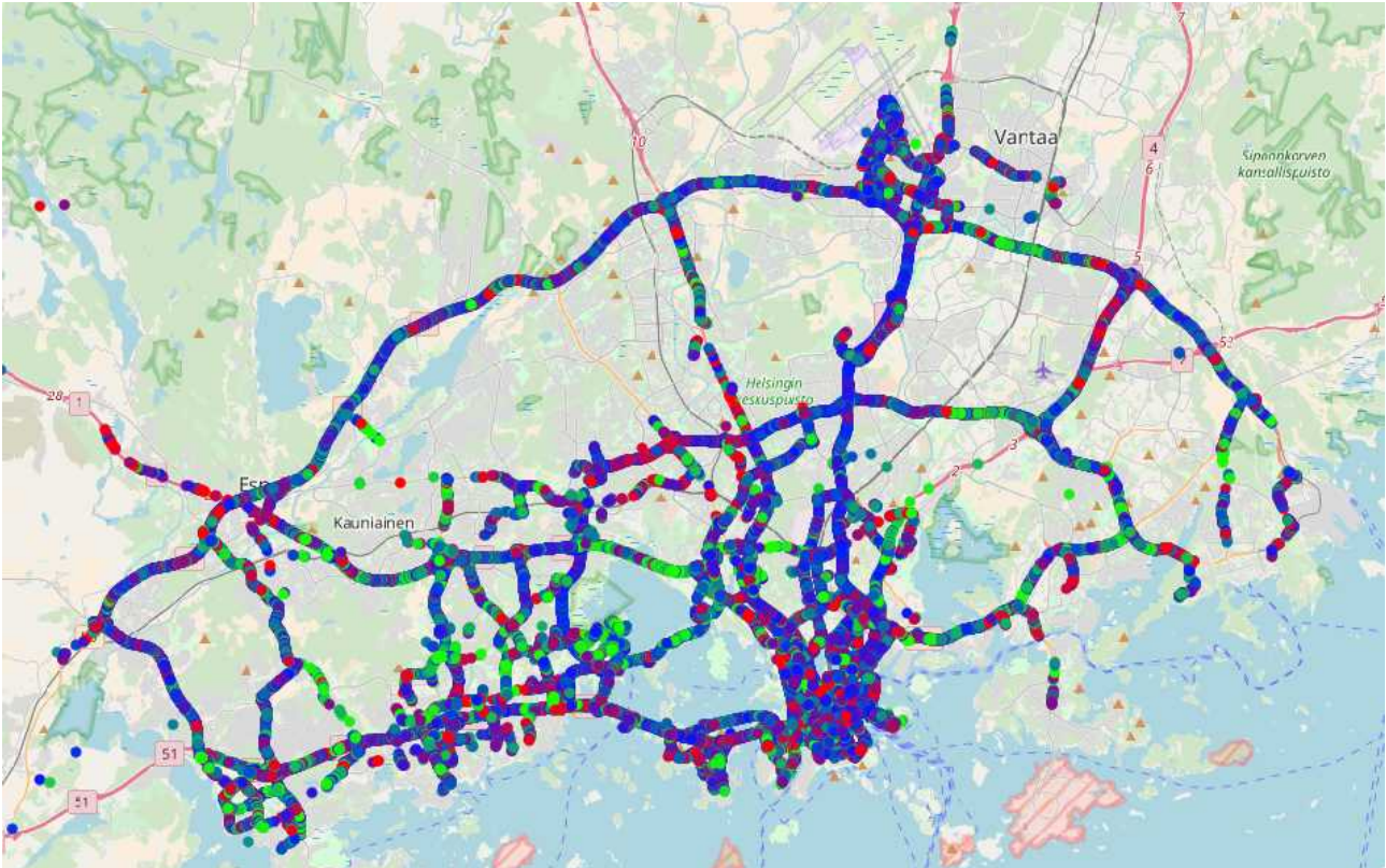
Kuva 4: Tien kunnan muutos kesäkuun ja syyskuun välissä 2017. (Parannus = Vihreä, Ei muutosta = Sininen, Laskenut = Punainen)
