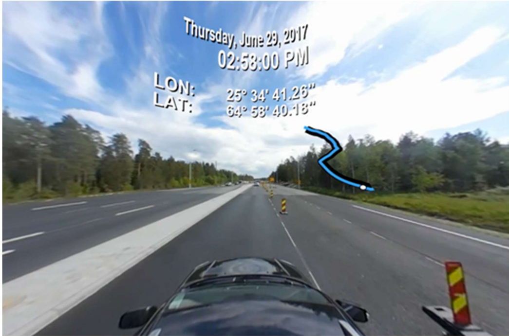
Kuva 21. 360 videoon lisättyä vaihtuvaa anturitietoa
