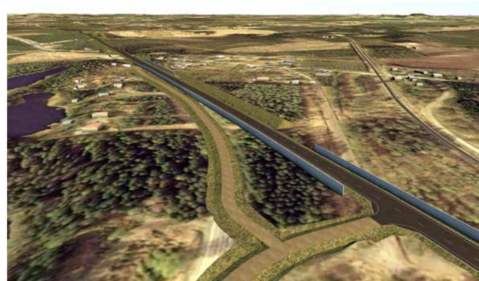
Kuva 5.14. Kaurilan kohdalla rakennetaan runsaasti melusteita, näkymä kaakosta.
