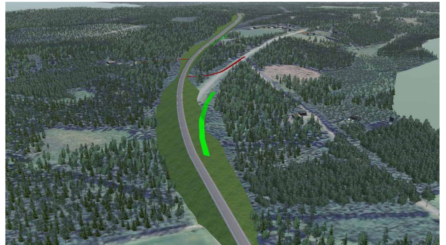
Kuva 7.15. Kemie C, näkymä itään. Swahnenvaaran jälkeen osa vaihtoehdoista erkanee uudelle valtatielinjaukselle. Tie-pengerrys on melko korkea. Uutta meluntorjuntaa rakennetaan erkanemiskohtaan (vihreä) ennen Kemieen johtavan vanhan valtatie liittymää (punainen).
