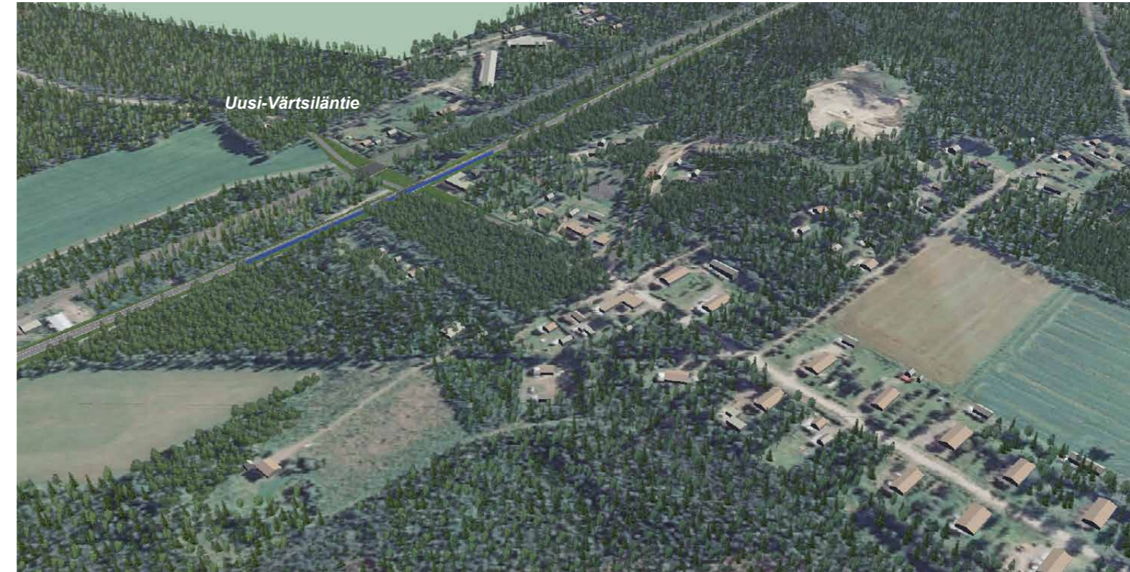
Kuva 7.25. Uusi-Värtsilä, näkymä. Uusi-Värtsiläntie kulkee uuden valtatielinjauksen ja radan ali. Meluntorjuntaa on suunniteltu uuden tielinjan eteläpuolelle (sininen).
