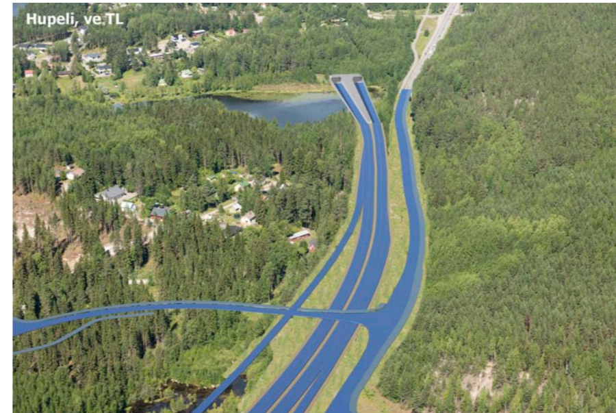
Kuva 42. Viistoilmakuvasovite: Alustaviin suunnitelmiin perustuva periaatekuva lyhyen tunnelin eteläisestä suuaukosta sekä siihen liittyvistä muista liikennejärjestelyistä. Näkymä etelästä kohti tunnelin suuaukkoa.
