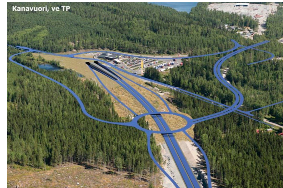
Kuva 44. Viistoilmakuvvasovite: Alustaviin suunnitelmiin perustuva periaatekuva pitkän tunnelin eteläisestä suuaukosta sekä siihen liittyvistä muista liikennejärjestelyistä. Näkymä etelästä kohti tunnelin suuaukkoa.
