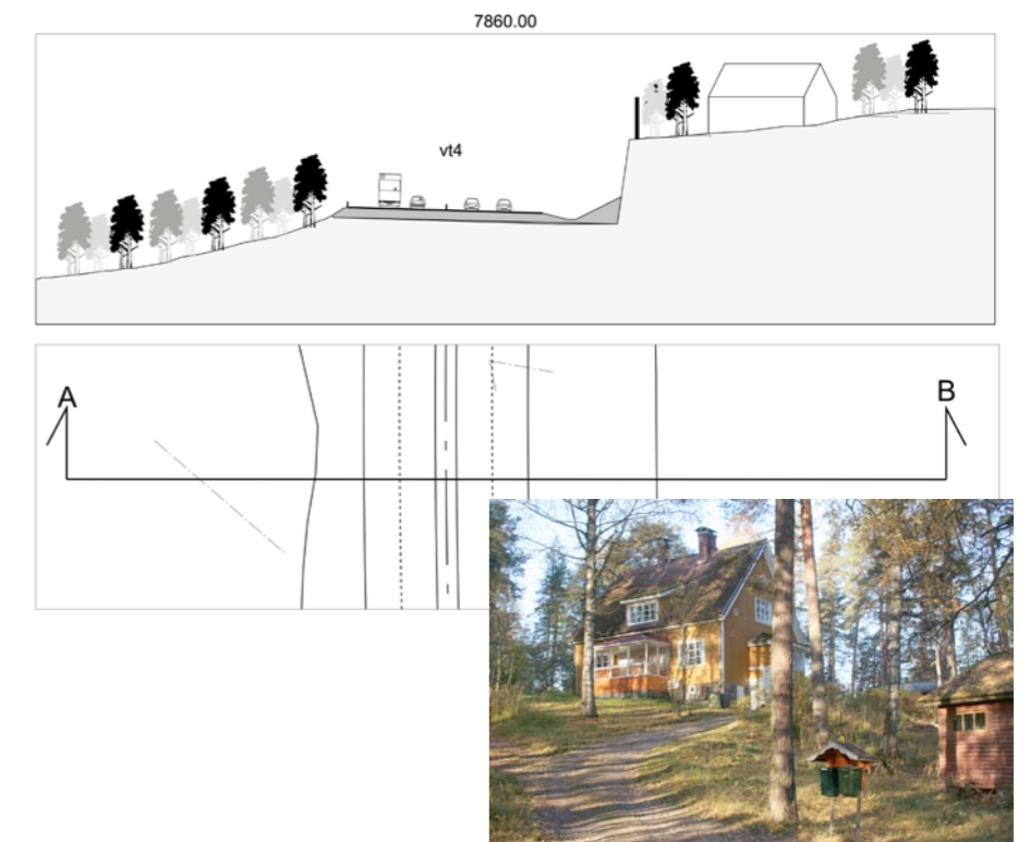
Kuva 36. Valtatien poikkileikkaus Varassaassa Poikalanmäen mestariasuntojen kohdalla, missä tie kulkee leikkauksessa. Asuintalojen pihat joudutaan suojaamaan melulta korkein meluseinän. Syksyllä 2010 otetun valokuvan etualalla oleva ulkorakennus joudutaan purkamaan.
