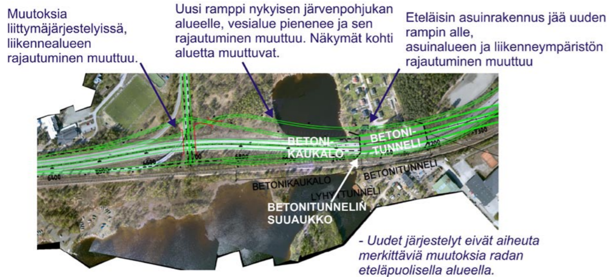
Kuva 41. Tunnelin pohjoisen suuaukon vaikutuksia kohdennettuna ilmakuvalle (sekä vaihtoehto TL (lyhyt tunneli) että TP (pitkä tunneli)).
