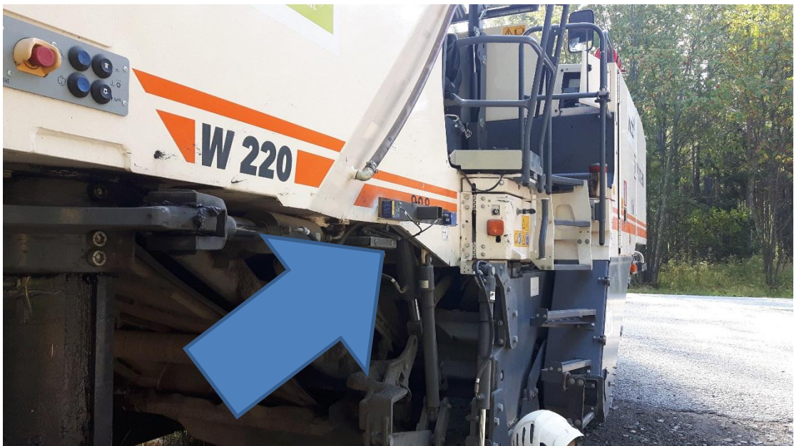
Kuva 3. Taka-anturin sijoittuminen jyrsimessä
