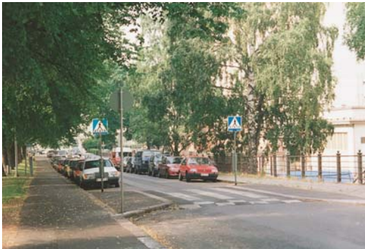
Kuva 103. Korotettu suojatie ja ajoradan kavennus yksisuuntaisella kadulla.
