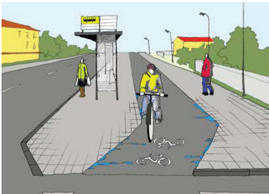
Kuva 54. Esimerkki jalankulkijoille ja pyöräilijöille tarkoitetun väylän linjaamisesta odotustilan ja katoksen takaa.
