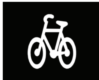
Kuva 158. Polkupyöräliikenteelle tarkoitettu tienosa.
